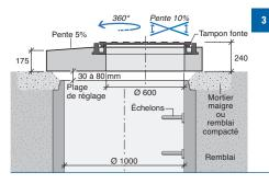
Déposer la dalle sur le remblai en orientant son ouverture par rapport aux échelons et aux contraintes de chaussées tout en respectant la plage de réglage de 30 mm minimum à 80 mm maximum.
