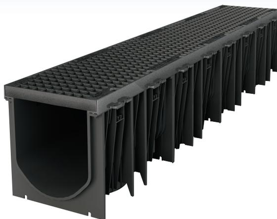
Le caniveau MAGNUM TRAFFIC se compose d'un corps en PE-HD (Polyéthylène Haute Densité) avec cornières fonte de 47 mm équipées de pattes pour ancrage latéral. Il est couvert d'une grille fonte de 0.50 m boulonnée par 4 vis ou d'une grille en acier galvanisé « caillebotis » de 1.00 m boulonnée par 8 vis. Caniveaux de 0.50 m avec grille en fonte. Caniveau de 1.00 m avec grille en acier galvanisé.
