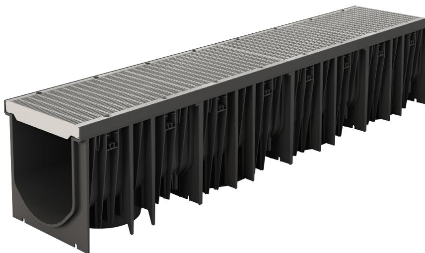
Le caniveau MAGNUM CITY se compose d'un corps en PE-HD (Polyéthylène Haute Densité) avec feuillure en PE-HD de 40 mm. Il est couvert d'une grille fonte de 0.50 m boulonnée par 4 vis ou d'une grille en acier galvanisée « caillebotis » de 1.00 m boulonnée par 8 vis. Caniveaux de 0.50 m avec grille en fonte. Caniveau de 1.00 m avec grille en acier galvanisé.
