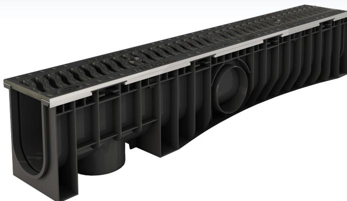
Le caniveau URBAN CITY® se compose d'un corps en PE-HD (Polyéthylène Haute Densité) avec profils en acier galvanisé. Il est couvert de 2 grilles fonte de 0.50 m fixées en leur centre par une barrette vissée.
