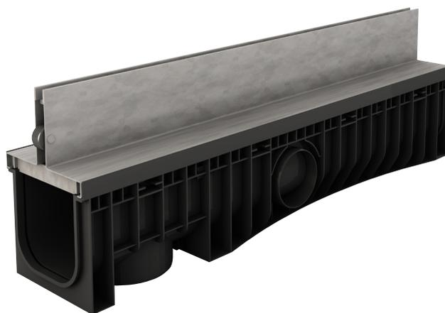
Le caniveau URBAN PROFIL® se compose d'un corps en PE-HD (polyéthylène Haute Densité) avec feuillure PE-HD de 25 mm (40 mm pour le 300). Il est couvert d'un profil à fente ouverture 18 mm. Il permet en zone urbaine l'intégration harmonieuse et esthétique d'une ligne de caniveaux. Caniveau de longueur de 1,00 m.
