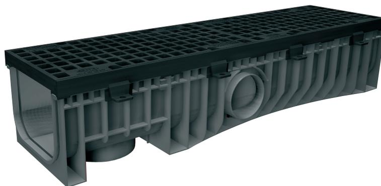
Le caniveau PROMAX se compose d'un corps en PE-HD (Polyéthylène Haute Densité) avec cornières fonte de 35 mm équipées de pattes pour ancrage latéral. Il est couvert de 2 grilles fonte de 0.50 m boulonnées par 4 vis.
