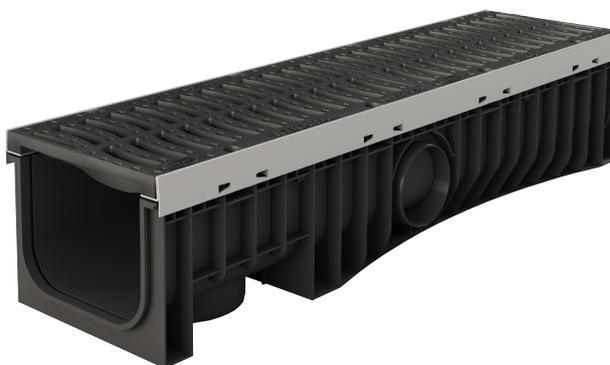
Le caniveau URBAN PRO® se compose d'un corps en PE-HD (Polyéthylène Haute Densité) avec profils en acier galvanisé. Il est couvert de 2 grilles fonte de 0.50 m boulonnées par 4 vis ou d'une grille en acier galvanisée de 1,00 m boulonnée par 4 vis.
