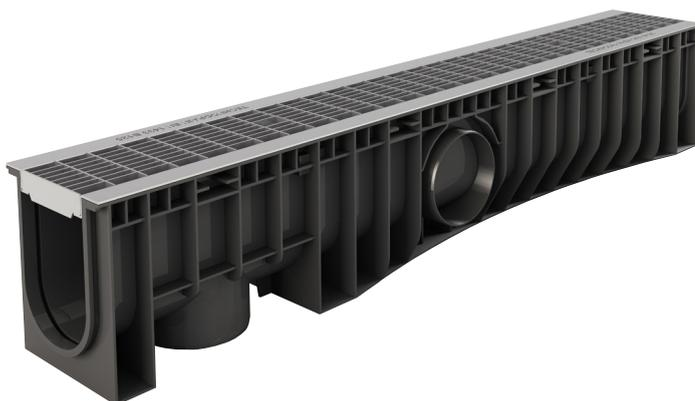
Le caniveau NEO se compose d'un corps en PE-HD (Polyéthylène Haute Densité) sans feuillure, couvert d'une grille en acier galvanisée « caillebotis » ou « passerelle » de 1,00 m, fixée par deux barrettes vissées.
