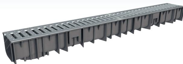
Le caniveau WAVE 90 se compose d'un corps en PE-HD (Polyéthylène Haute Densité) largeur 90 mm couvert d'une grille passerelle en acier galvanisé recouvrant les bords du caniveau. En option, kit de 2 barrettes de fixation.
